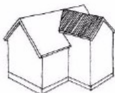
Tilbygg i 2 etasjer. Felles mønehøyde og takform på tilbygg og hovedhus.
