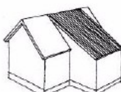
Tilbygg i 2 etasjer. Tilbygget har en annen takform enn hovedhuset og konkurrerer i størrelse.
