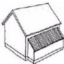
Bredden på tilbygget står i forhold til hovedhuset. Like takvinkler.
